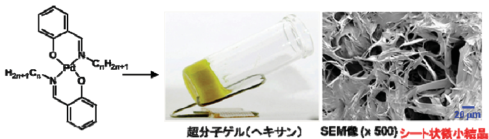
図 2. Pd アルジミン錯体の超音波ゲル化とゲル繊維の SEM 像
