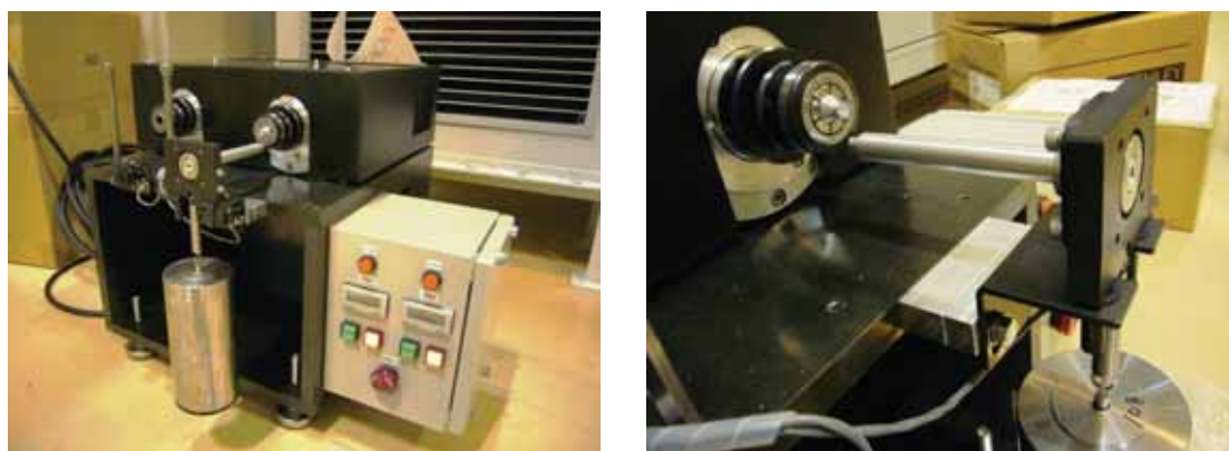
図 6 回転曲げ疲労試験機の外観 (左) と試験片破断後の様子 (右)
