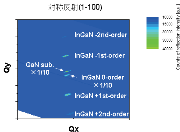
図1. 非極性m面InGaN/GaN超格子構造における逆格子マップ結果
