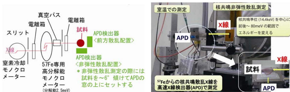
図 1. BL09XU での核共鳴散乱測定のセットアップ。
