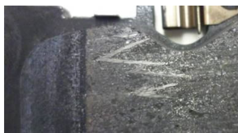
図 1. ブレーキパッド表面に発生した代表的な MPU
