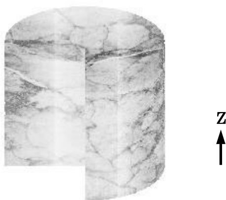
図3 セクショントポグラフから3次元構築した蛍石のサブグレイン構造 (内部構造をわかりやすくするために円柱の1/4除去した)
